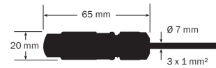
Anschlusskabel 5 m mit RST-Stecker 5 m connection cable with RST plug Câble de connexion 5 m une fiche de RST
